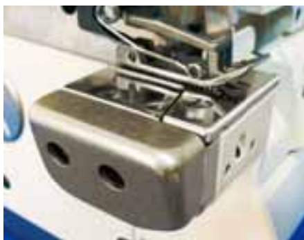
筒縫いの地縫い・裾引きに最適な小径シリンダー。
