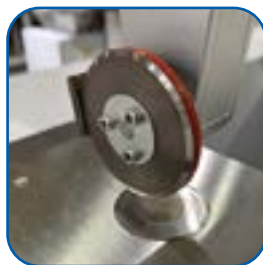
Anvil and Sonotrode
