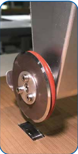
Anvil and Sonotrode
