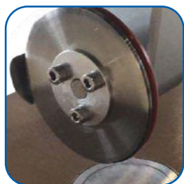
Anvil and Sonotrode
